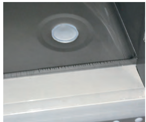
BONDE D'ÉVACUATION DES EAUX DE NETTOYAGE
